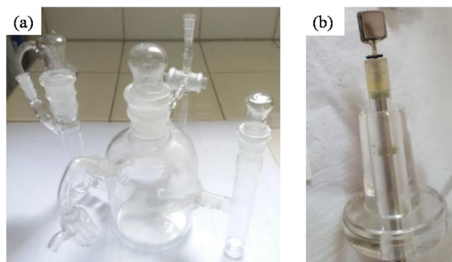
Figura 1. (a) Celda electroquímica. (b) Electrodo de acero al carbono pulido mecánicamente y anclado a su respectivo soporte.
