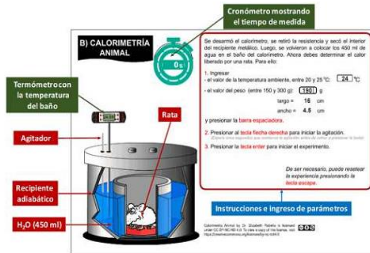
FIGURA 6. Imagen de la interfaz gráfica de la simulación para ejecutar la determinación de calor liberado por la rata. En azul se muestran los controles de usuario y en verde la salida de datos.
