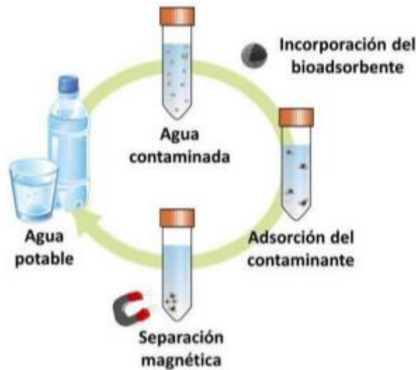
FIGURA 1. Esquema de ensayo de materiales bioadsorbentes para la remediación de contaminantes
