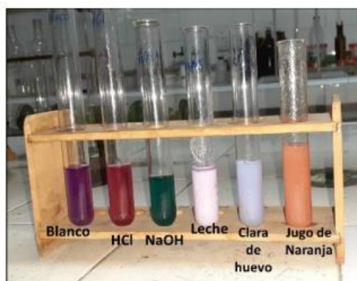
FIGURA 4. Muestras y resultados obtenidos durante el ensayo del cambio de color de las antocianinas.
