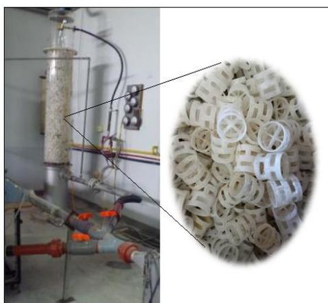
**Figura 2:** Torre empacada rellena con anillos Pall.
