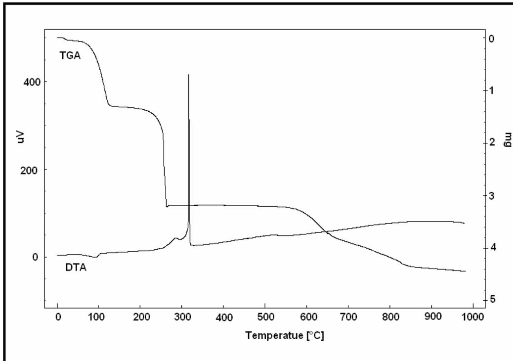
Fig.3. TGA-DTA curves of  $\text{SrNH}_4[\text{Fe}(\text{CN})_6] \cdot 3\text{H}_2\text{O}$  in oxygen.
