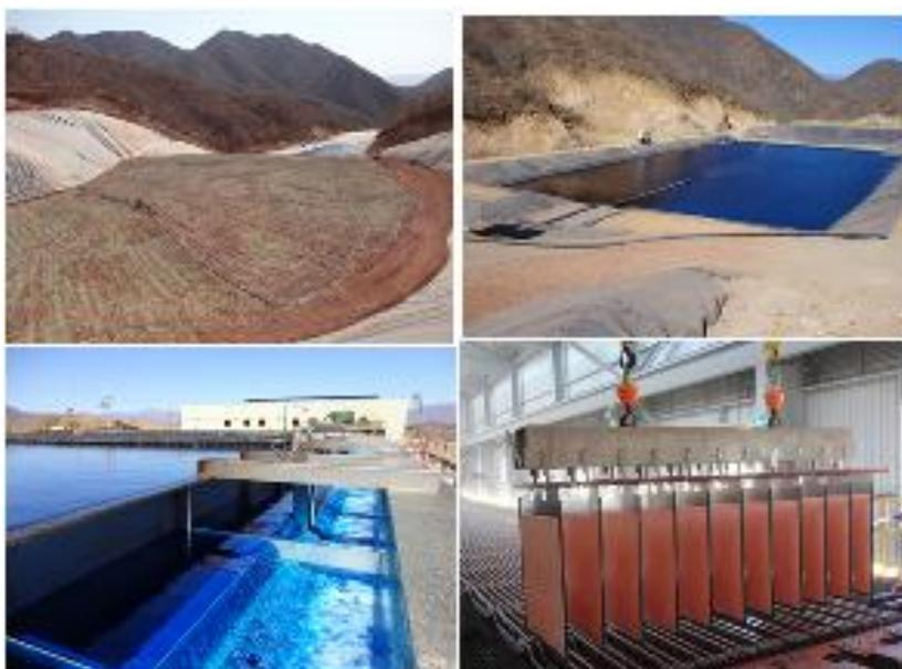
*Figura 4: Etapas de la minería de cobre: arriba a la izquierda, valle de lixiviación; debajo del mineral hay una capa impermeabilizante; arriba a la derecha, agregado de ácido sulfúrico al mineral; abajo a la izquierda recolección de la solución resultante de sulfato de cobre para su procesamiento por extracción de solventes y posterior electrodeposición; abajo a la derecha: cátodos de hierro con el cobre, una vez extraídos. Tomado de [11]*
